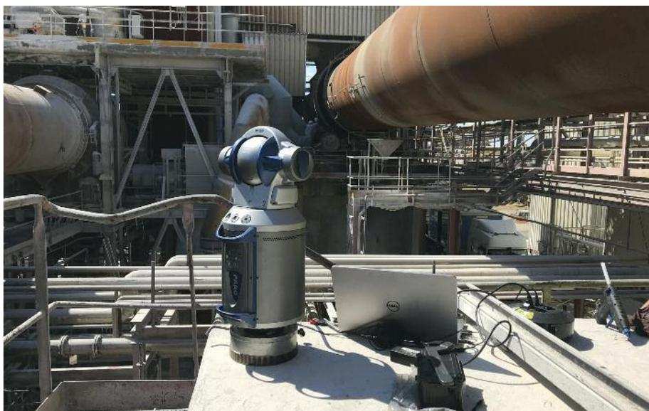
Utilisation du Laser Tracker sur un four de calcination dans le domaine de la papeterie (longueur du four : 60 mètres – présence de 3 points d'appui).
